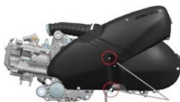
Rys.1 Wciśnij dwie gumowe zatyczki i usuń 6 śrub
