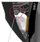
pokrywa zbiornika uzupełniającego
