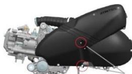
Rys.1 Wciśnij dwie gumowe zatyczki i usuń 6 śrub
